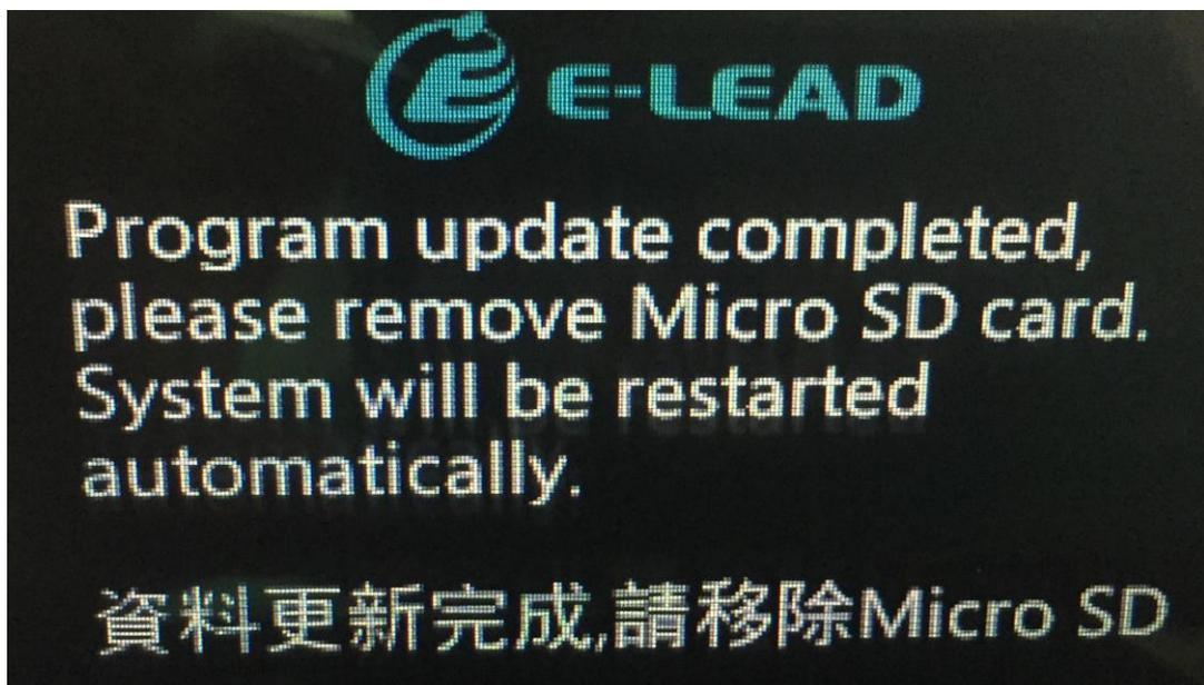
\*圖資更新完成退出Micro SD卡後，音響系統將會自動“重新開機”進入SmartHUD正常開機畫面，此時系統會開始建立開機檔案，請靜待約30秒左右，系統會進入睡眠狀態(螢幕會關閉)，螢幕關閉後約15秒左右系統會自動“重新開機”，更新流程完成。
